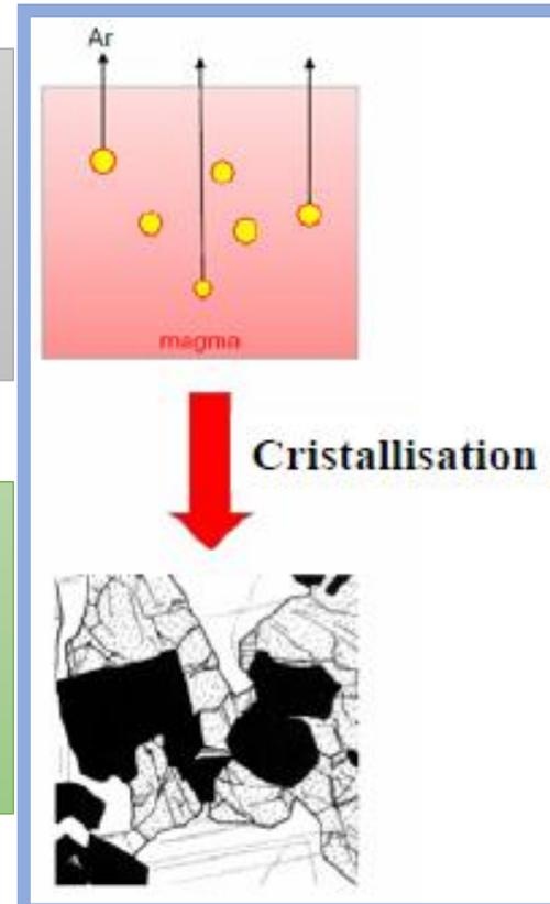
Quand le magma se refroidit et se transforme en roches, le  $^{40}\text{Ar}$  issu de la désintégration du  $^{40}\text{K}$  reste emprisonné dans les cristaux. La roche cristallisée constitue un système fermé.
